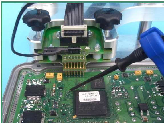
Bild 1: Der BSL130 Tastkopf auf dem 14-poligen Pad-Array und die Bootpin Sonde (rechts).
