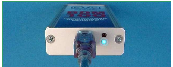
Bild 2: Das BSL100-Modul wird immer zuerst mit dem USB-Kabel des PCs verbunden.
