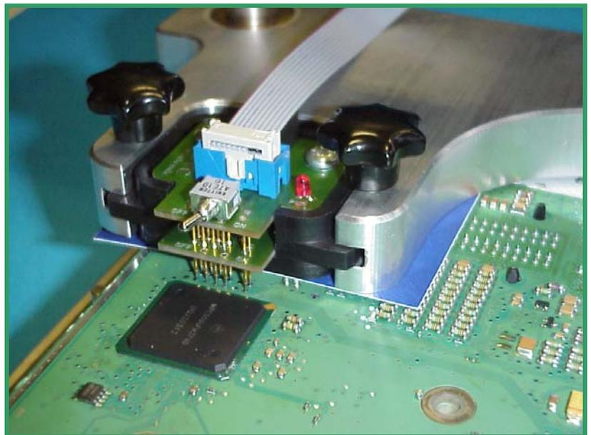
**Bild b: So wird der BDM143 Tastkopf auf der Platine des EDC7 Steuergerätes platziert.**
