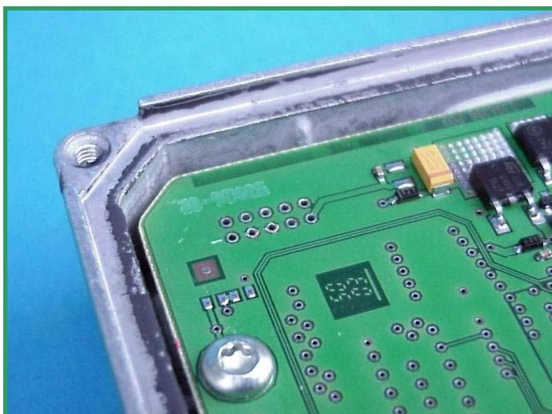
**Bild b:** Die Lage der BDM-Pads beim Delphi-Steuergerät. Der Pin 1 ist hier schon gekennzeichnet.
