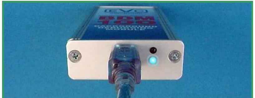
**Bild a: Das BDM100-Modul wird immer zuerst mit dem USB-Kabel des PCs verbunden.**
