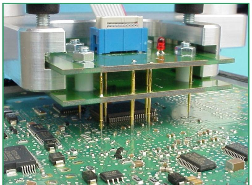
**Bild c: Die Spitzen der Federkontaktstifte sollten mindestens 2mm einfedern, um sicheren Kontakt zu gewährleisten**
