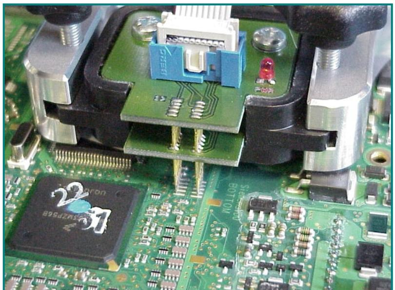
**Bild c: Das BDM141 kontaktiert die BDM-Pads.**
