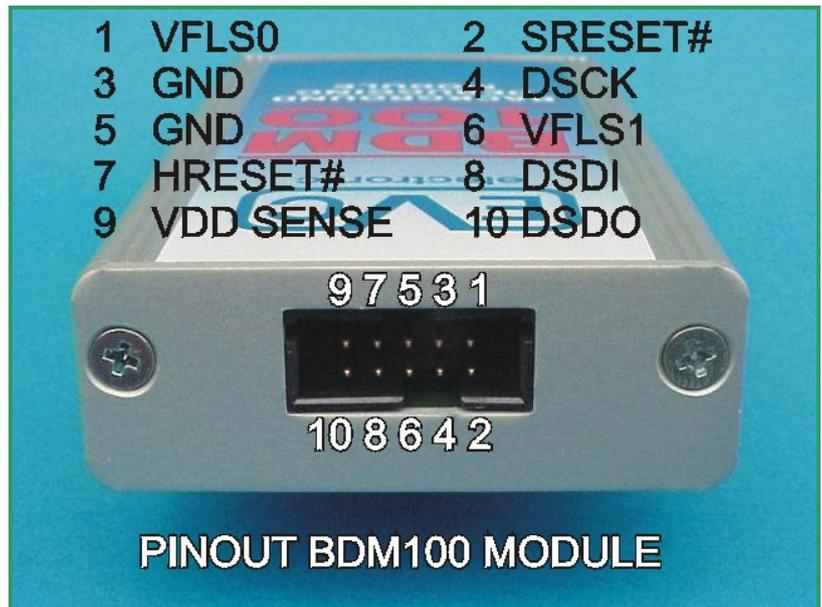
Bild a: Die Pinbelegung der 10-pol. Steckerwanne
