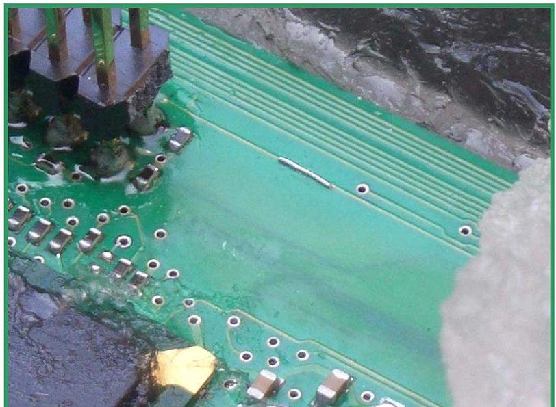
**Bild c: Die wiederhergestellte Verbindung.**
