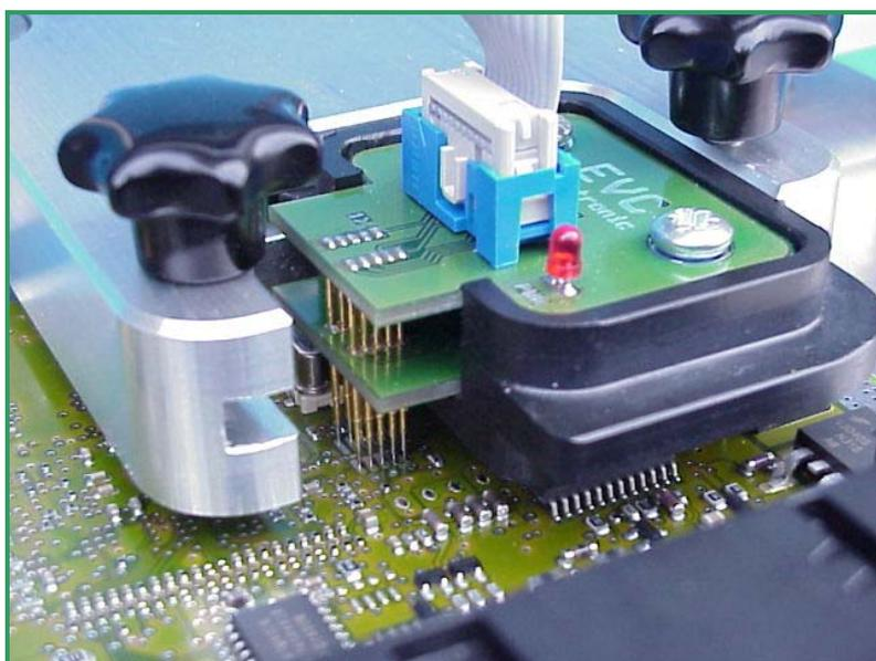
**Bild c: Das BDM141 kontaktiert die BDM-Pads.**
